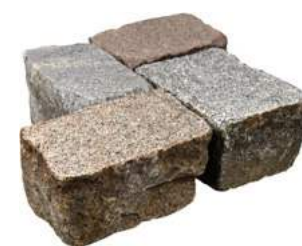
Granit-Großpflaster, bunt ca. 15-26x13-15x13-17 cm Oberfläche gesägt und geflammt
