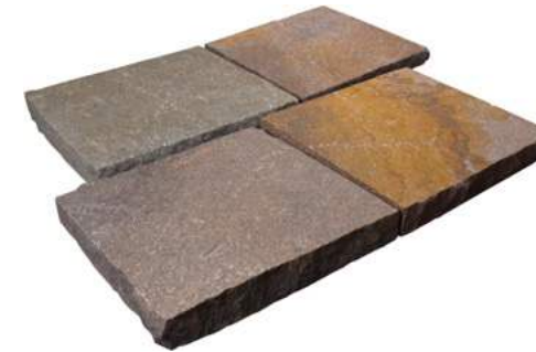
Porphyr, rot-braun-bunt, Bahnenware OF gespalten, Seiten handbekantet Breite: 30 cm + 40 cm, Stärke: 2-6 cm
