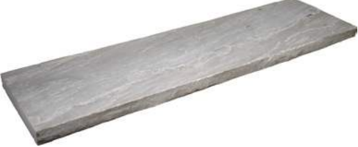
Sandstein-Mauerabdeckung 100x30x4 cm, Oberfläche spaltrau und gebürstet, Längsseiten handbekantet, mit beidseitiger Wassernase + Endstücke
