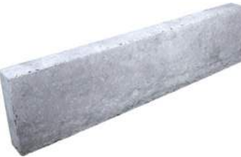
Kalkstein, Belgisch Blaustein ca. 8x25 cm, Oberfläche ENOSTYL® HELL (patiniert und Kanten gebrochen)
