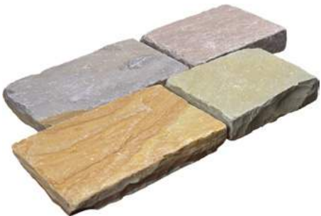
Sandstein, Desert-yellow-brown allseits gespalten und getrommelt, Seiten handbekantet 25-40x20x6 cm
