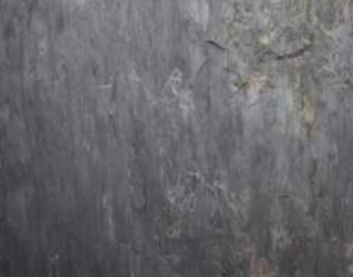
Schiefer 100x45-55x3-7 cm und 300x45-55x3-7 cm, Vorder- und Rückseite gespalten, Seiten gesägt
