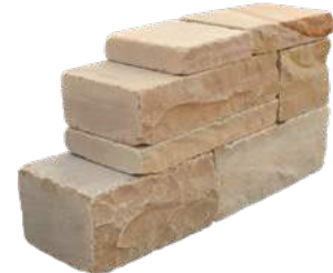
Sandstein-Rebmauerwerk Längen: 20, 30, 40 cm, Breite: 20 cm, Schichthöhen: 5, 10, 15 cm, Stoß- und Lagerfugen gesägt, Sichtflächen gespalten, getrommelt
