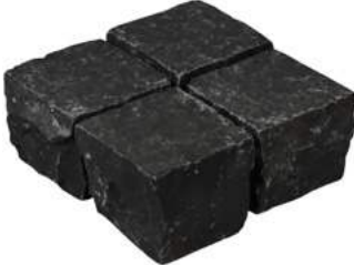
Basalt-Kleinpflaster ca. 9x9x8 cm, Oberfläche geflammt, wassergestrahlt und gebürstet
