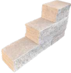
Kalkstein-Trockenmauersteine, Typ Pula ca. 30-60x20x15 cm, Stoß- und Lagerfugen gesägt, Längsseiten gespalten, getrommelt + Endstücke
