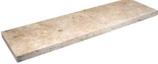
Travertin-Mauerabdeckung 100x30x4 cm, Oberfläche und beide Längsseiten geschliffen, mit beidseitiger Wassernase
