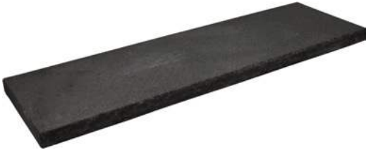
Basalt-Mauerabdeckung 100x30x4 cm, Oberfläche wassergestrahlt und gebürstet, Längsseiten bossiert, mit beidseitiger Wassernase + Endstücke
