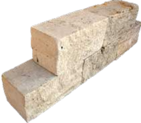
Travertin-Trockenmauersteine, Classico beige ca. 40x20x20 cm, Stoß- und Lagerfugen gesägt, Längsseiten bossiert, getrommelt
