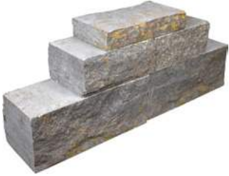
Kalkstein-Systemmauerwerk freie Längen, Breite: 18 cm, Schichthöhen: 6, 12, 18 cm Stoß- und Lagerfugen gesägt, Sichtflächen gespalten + Endstücke
