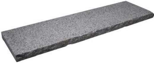
Granit-Mauerabdeckung 100x30x4 cm, Oberfläche geflammt und gebürstet, Längsseiten bossiert, mit beidseitiger Wassernase + Endstücke
