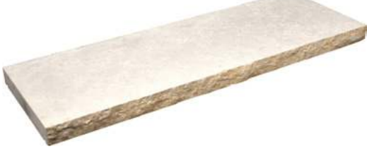
Kalkstein-Mauerabdeckung 80x28x4 cm (Typ Pula), Oberfläche sandgestrahlt und gebürstet, Längsseiten bossiert, mit beidseitiger Wassernase + Endstücke
