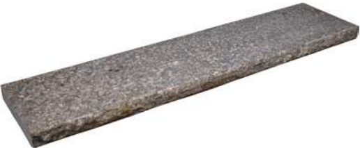
Kalkstein-Mauerabdeckung 100x24x4 cm, Oberfläche geschliffen, Längsseiten bossiert, mit beidseitiger Wassernase + Endstücke
