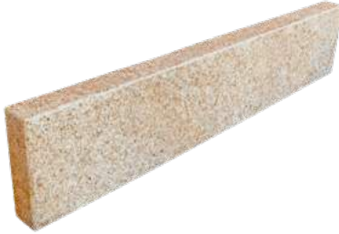
Granit, Moreno-antik allseits gesägt, geflammt und 3-fach gebürstet 100x20x6 cm
