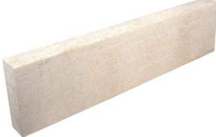
Kalkstein, Kanfanar, OF und eine Längsseite sandgestrahlt und gebürstet, restliche Seiten gesägt 100x25x8 cm
