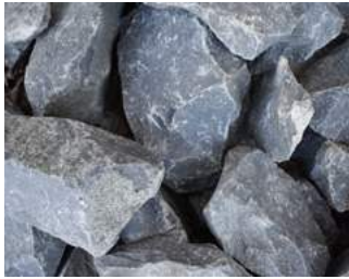
Basalt-Wasserbausteine CP 90/250, gebrochen
