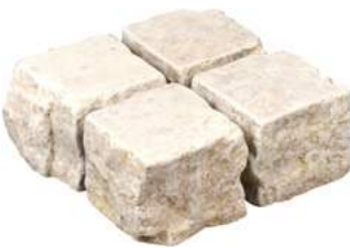
Kalkstein-Kleinpflaster ca. 9x9x8 cm 2 Seiten gesägt, 4 Seiten gespalten, getrommelt
